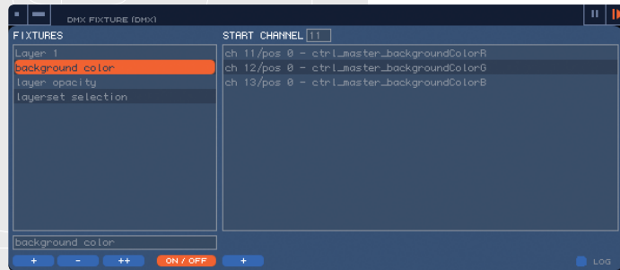
Un exemple de fixture configuré en 'pos 0' pour contrôler la couleur de fond.
